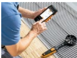
KIT MEDICIÓN DE CAUDAL HILO CALIENTE + MOLINETE
