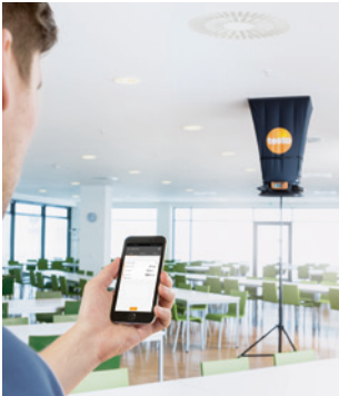
Conexión a la aplicación por medio de Bluetooth para visualizar los datos medidos en los dispositivos móviles y concluir el protocolo de medición desde el lugar de medición.
