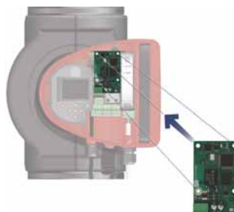
Fig. 48 Ubicación del módulo CIM
