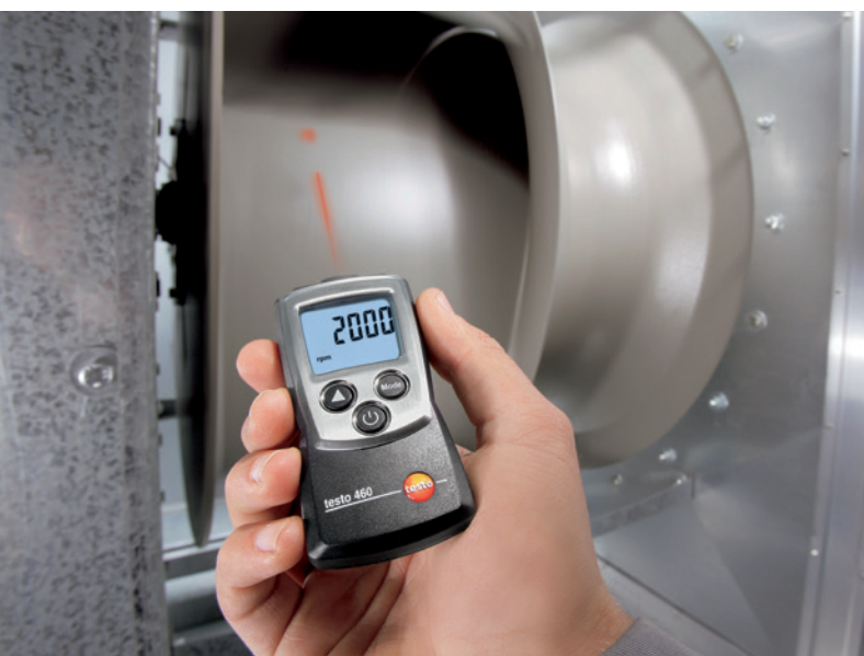
Para las mediciones sin contacto en ventiladores puede utilizar por ejemplo el testo 460. En el objeto de medición aparece una marca LED que indica el punto de medición.
