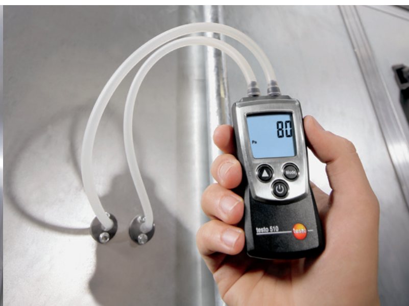
Para saber con seguridad si un filtro está sucio utilice los medidores de presión diferencial de Testo, como el testo 510.
