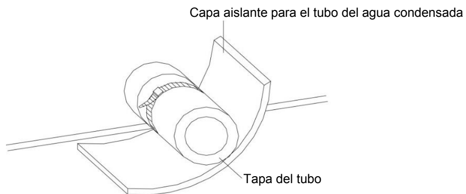
Fig.13 Aislamiento térmico del tubo del agua condensada
